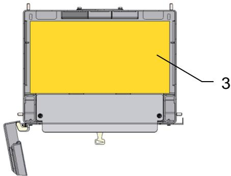
Bodenplatte (3) mit Sichtseite nach oben in den Brennraum einlegen, zu den Seitenwänden ausmitteln und nach vorne schieben.
