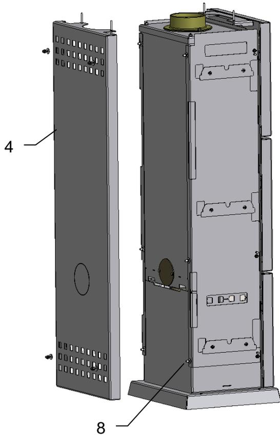
Die Rückwand (4) von hinten auf die vier Gewindebolzen (8) stecken und mit Beilagscheiben und Hutmuttern (9) verschrauben.
