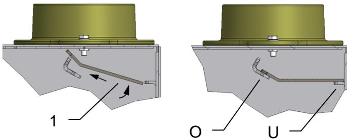
Stahlumlenkplatte (1) wie abgebildet in den Brennraum einfahren und auf den oberen (O) und hinteren (U) Auflegewinkel ablegen.
