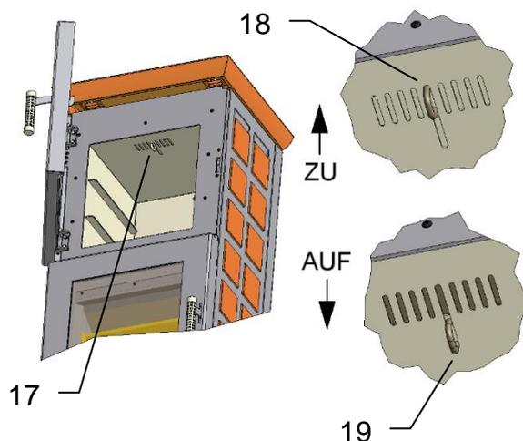
Im Backfach oben befindet sich der Dampfabzugsschieber (17).
