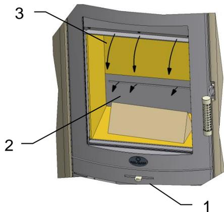
Die für den Abbrand benötigte Verbrennungsluft wird über den Luftschieber (1) geregelt. Mit dem Luftschieber (1) wird die Primärluft (2) und die Sekundärluft (3) mit einem Hebel geregelt.
