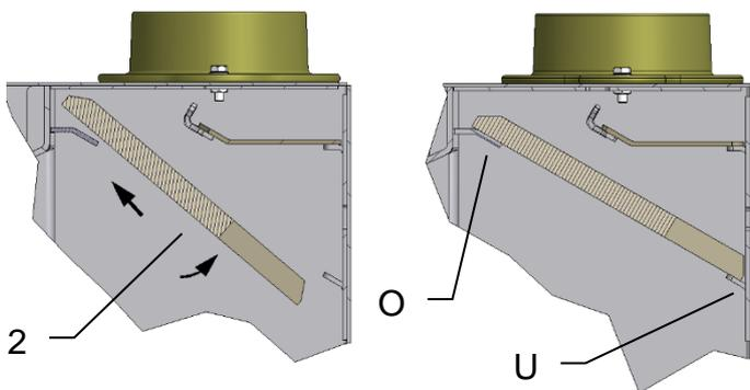
Umlenkplatte (2) wie abgebildet in den Brennraum einfahren und auf den oberen (O) und hinteren (U) Auflegewinkel ablegen.
