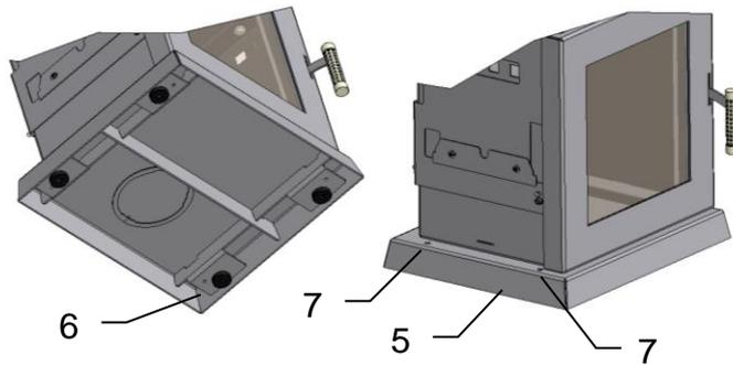
Kaminofen (1) an den Aufstellungsort bringen und mit Wasserwaage auf waagrechte Position prüfen.
