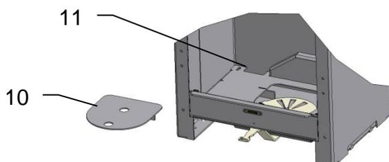
Zum Reinigen der Brennkammer die Brennumraumauskleidung komplett ausbauen.
