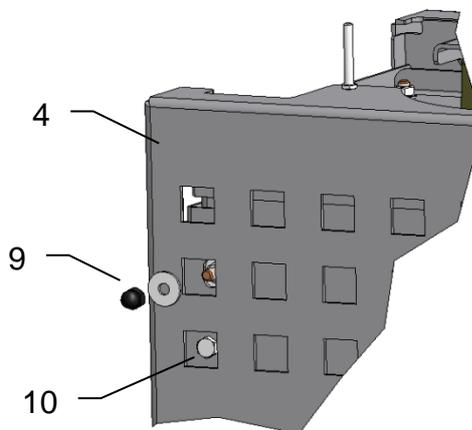
Bei Bedarf kann das Spaltmaß der Rückwand (4) über die Schrauben (10) eingestellt werden.
