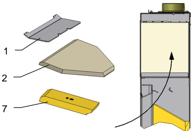
Zum Reinigen der Ofenrohre können die Umlenplatten (1) und (2), sowie die Deckelplatte (7) entfernt werden.
