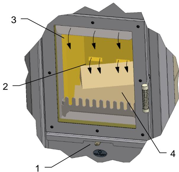
Die für den Abbrand benötigte Verbrennungsluft wird über den Luftschieber (1) geregelt. Mit dem Luftschieber (1) wird die Primärluft (2) und die Sekundärluft (3) mit einem Hebel (1) geregelt.
