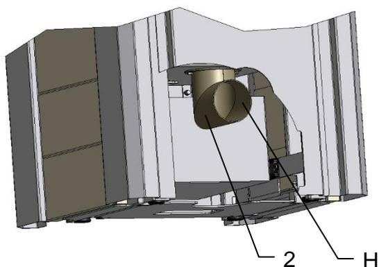
Bei Außenluftanschluß nach hinten (H) erfolgt der Anschluß mit einem abgewinkelten Außenluftstutzen (2).
