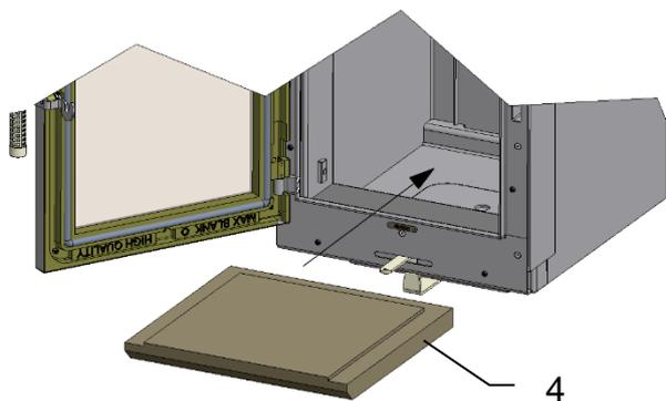
Bodenplatte (4) mit Sichtseite nach oben in den Brennraum einlegen, zu den Seitenwänden ausmitteln und nach vorne schieben.
