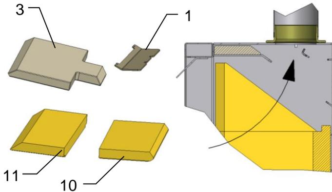
Zum Reinigen der Ofenrohre können die beiden Umlenkplatten (1) und (3), sowie die beiden Deckelplatten (10) und (11) ausbauen.
