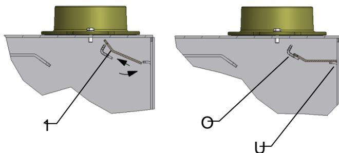
Stahlumlenkplatte (1) wie abgebildet in den Brennraum einfahren und auf den oberen (O) und hinteren (U) Auflegewinkel ablegen.
