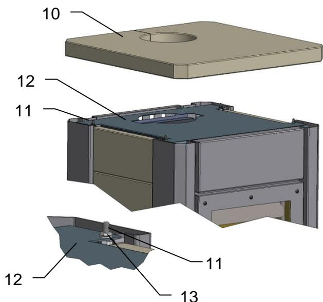
Das Konvektionsblech (12) auf die Fixierstifte (11) auffädeln und mit Sechskantmutter (13) befestigen.
