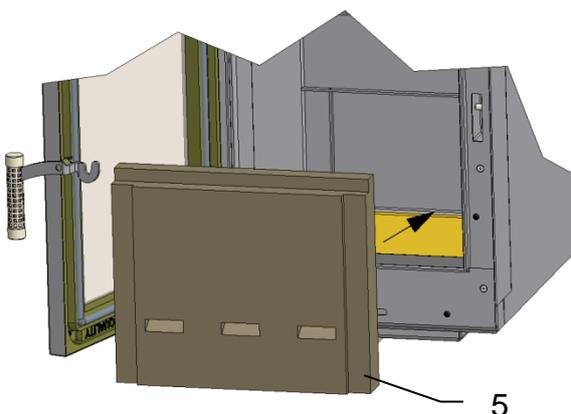
Den Rückwandstein (5) mit Sichtseite zum Feuerraum einsetzen und ausmitteln und ganz nach hinten schieben.
