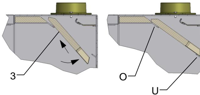
Umlenkplatte (3) wie abgebildet in den Brennraum einfahren und auf den oberen (O) und hinteren (U) Auflegewinkel ablegen.
