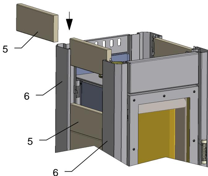
Die Seitensteine (5) mit der Fase nach außen von oben in die Eckprofile (6) einfädeln und nach unten führen.
