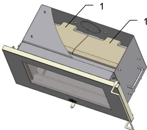
Die beiden Umlenkplatten (1) müssen wie abgebildet montiert sein.
