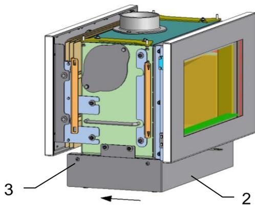
Die Blende (2) von vorne auf Sockel schieben und mit den Schrauben (3) befestigen.
