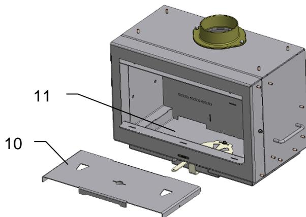
Zum Reinigen der Brennkammer die Brennraumauskleidung komplett ausbauen. Den Revisionsdeckel (10) entnehmen. Den Brennraumboden und die Luftkanäle (11) mit einem geeigneten Staubsauger säubern.
