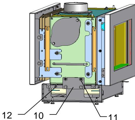
Den Kaminofen und Sockel an den Verbindungsplatten (10) mit den Muttern (11) verschrauben.
