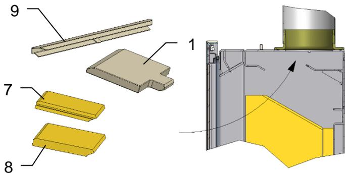
Zum Reinigen der Ofenrohre können der Schamottehalter (9) und die beiden Deckensteine (7) und (8), sowie die beiden Umlenkplatten (1) entfernt werden
