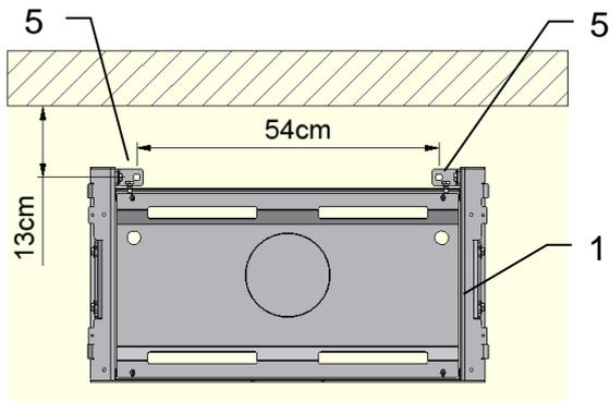
Den Sockel (1) mit den Haltern (5) am Boden befestigen.
