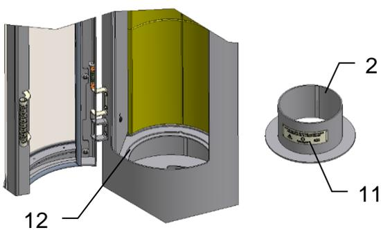
Insérer l'adaptateur de la cassette à pellets (2) dans le plancher du foyer (12). S'assurer que l'écriteau (11) se trouve vers l'avant.
