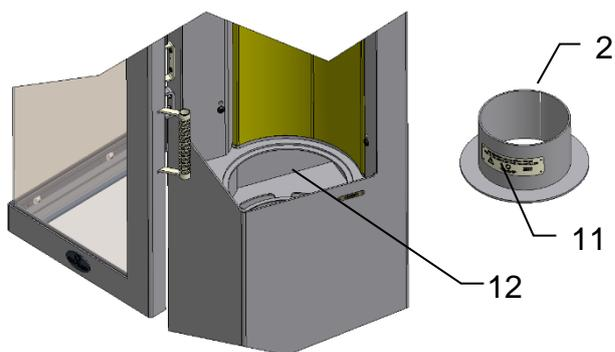
Insérer l'adaptateur de la cassette à pellets (2) dans le plancher du foyer (12). S'assurer que l'écriteau (11) se trouve vers l'avant.
