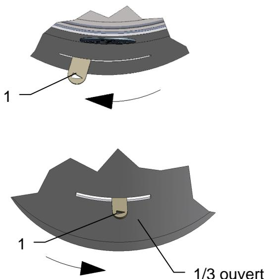
L'air nécessaire à la combustion est réglée par la manette de réglage d'air (1). Manette de réglage à gauche selon le symbole de la flèche ci-contre :
