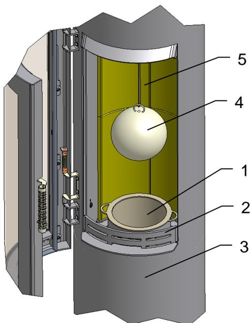
Après avoir monté le cendrier (3), l'adaptateur (2), la cassette à pellets (1) ainsi que la boule (4) avec la tige de fixation (5), le poêle est prêt pour une utilisation au mode pellets.
