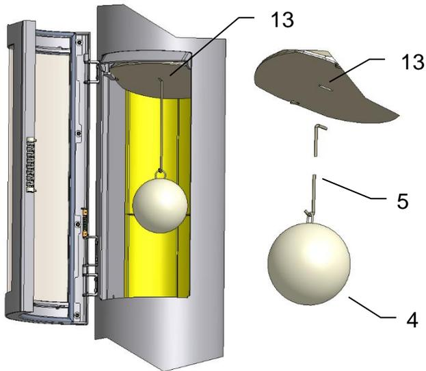
Fixer la tige de fixation (5) dans la fente de la plaque déflectrice (13).
