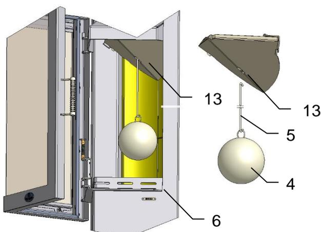
Fixer la tige de fixation (5) dans la fente de la plaque déflectrice (13).
