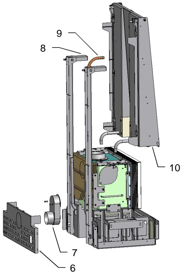
Die Sockelrückwand (6) durch Lösen der 4 seitlichen Schrauben abnehmen.
