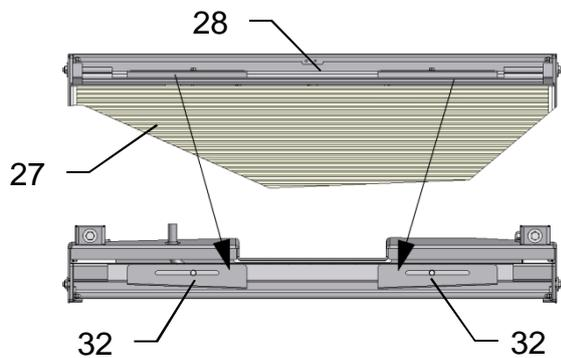
Durch verschieben der Winkel (32) im Wasserverteiler (28) kann bei Bedarf die Wasserverteilung beeinflusst werden.
