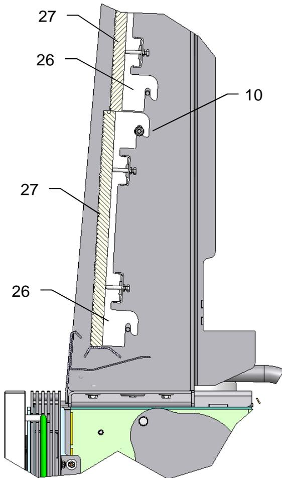
Den unteren vormontierten Wasserwandstein (27) in die seitlichen Bolzen der Wasserwand (10) einhängen und die oberen Haken verschrauben.
