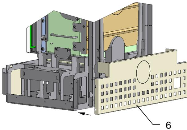
Die Sockelrückwand (6) aufschieben und mit 4 Schrauben seitlich befestigen.
