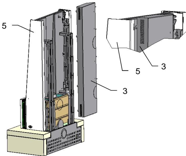
Das rechte Rückwandelement (3) mit den Haken in die Schlitz der rechten Seitenverkleidung (5) einhängen.
