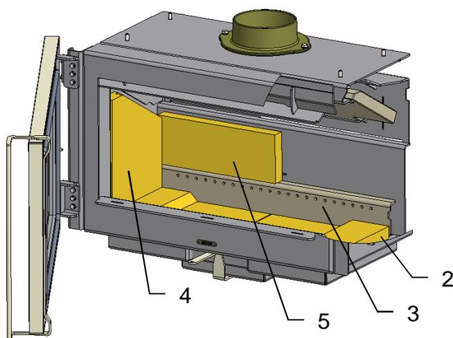
Primärluftleiste (3) mit den Luftaustrittsöffnungen oben in den Spalt zwischen den Bodenplatten (2) und der Ofenrückwand einsetzen und ausmitten.
