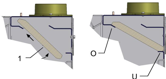
2 Umlenkplatten (1) wie abgebildet in den Brennraum einfahren und auf den oberen (O) und hinteren (U) Auflegewinkel ablegen.
