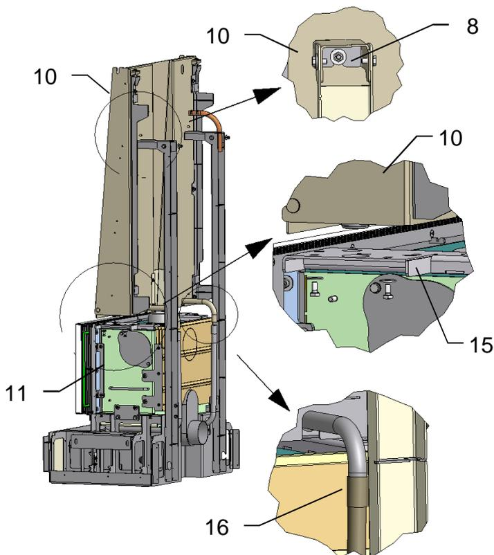
Die Wasserwand (10) von vorne auf die Adapterplatten (15) vom Brennraum (11) stellen und verschrauben.
