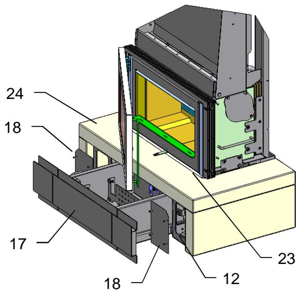
Den Abdeckwinkel (23) nach unten drücken bis dieser auf der Sockeldeckplatte (24) aufliegt.
