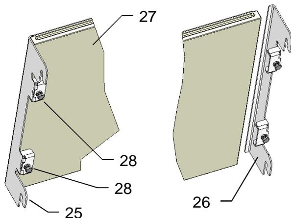
Je einen Steinhalter rechts (25) und links (26) seitlich an die Wasserwandsteine (27) anlegen und mit den Schrauben (28) leicht klemmen.
