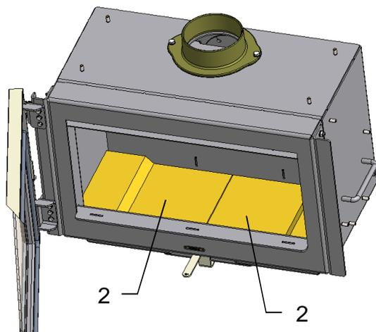
Die beiden Bodenplatten (2) in den Brennraum einlegen, zu den Seitenwänden ausmitten und nach vorne schieben.
