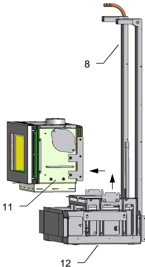
Die 4 Muttern seitlich am Brennraum (11) lösen und diesen vom Sockelgestell (12) herunterheben.
