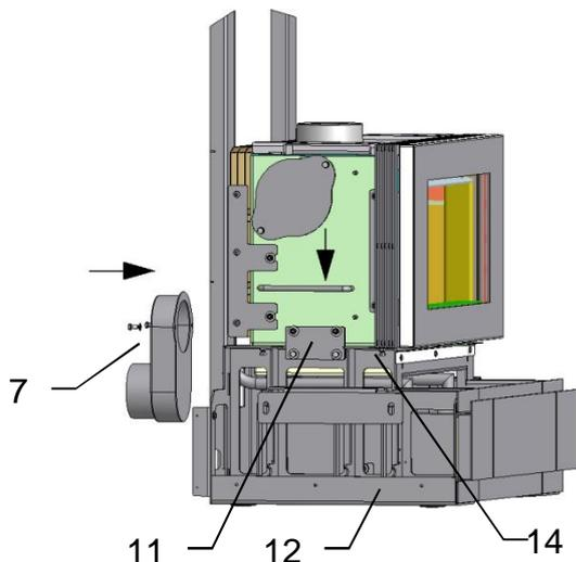
Den Brennraum mit Hilfe der Traggriffe in die Verbindungsplatten (11) des Sockelgestells (12) setzen und miteinander verschrauben.
