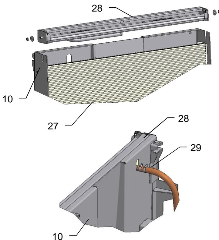
Vor der Montage des obersten Wasserwandsteines (27) den Wasserverteiler (28) durch Lösen der seitlichen Muttern entfernen.
