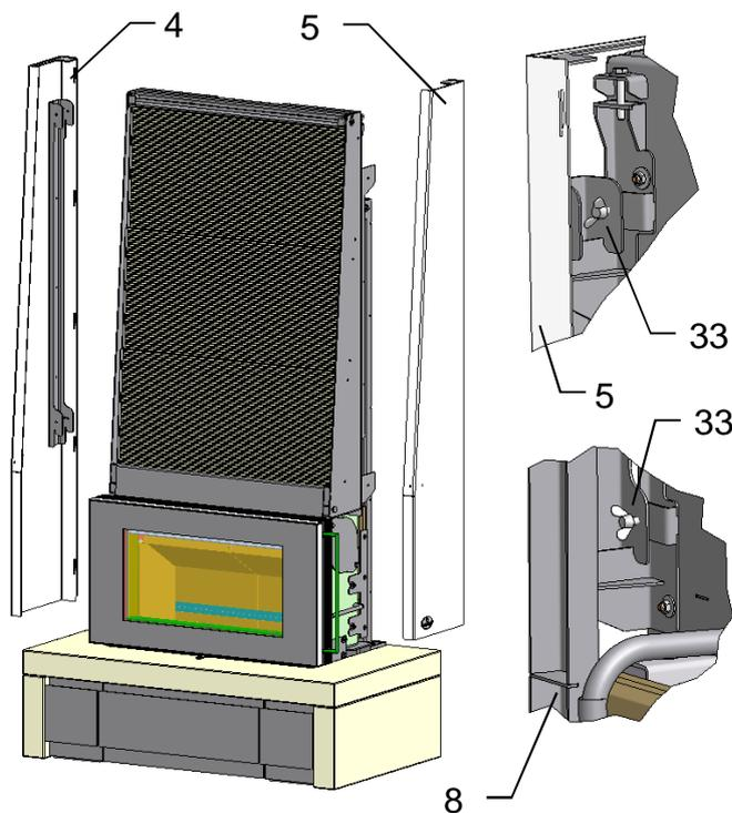
Die linke (4) und die rechte (5) Seitenverkleidung mit den Haken seitlich in die Wasserwand einhängen.
