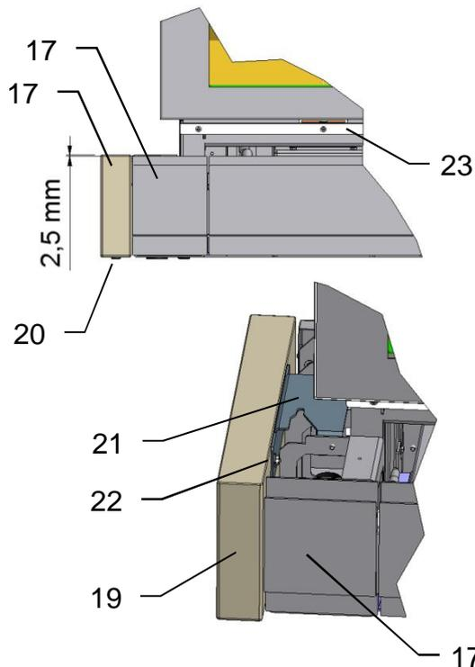
Die Stellschrauben (20) so einstellen, dass die Obere Kante des Seitensteines (19) 2,5 mm über der Kante von der Schublade (17) liegt.
