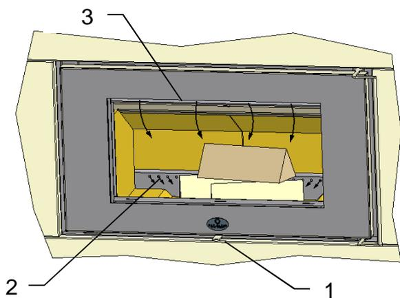
Die für den Abbrand benötigte Verbrennungsluft wird über den Luftschieber (1) geregelt. Mit dem Luftschieber (1) wird die Primärluft (2) und die Sekundärluft (3) mit einem Hebel geregelt.
