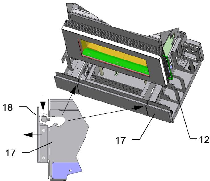
Zum Öffnen der Wasserschublade (17) die beiden Sicherungshaken (18) drücken und die Schublade herausziehen.
