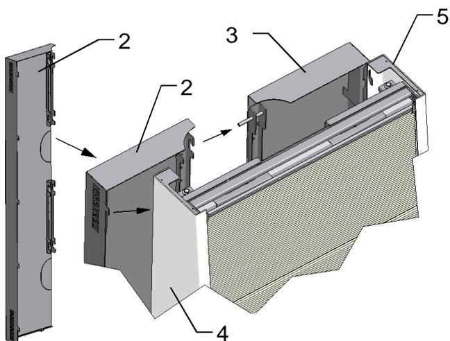
Das linke Rückwandelement (2) mit den Haken auf die Bolzen des rechten Rückwandelementes (3) aufschieben und in die Schlitz der Seitenverkleidung (4) einhängen.
