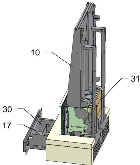
Die Wasserschublade (17) bis zur Maximum Markierung (30) mit Wasser befüllen und die Pumpe einschalten.
