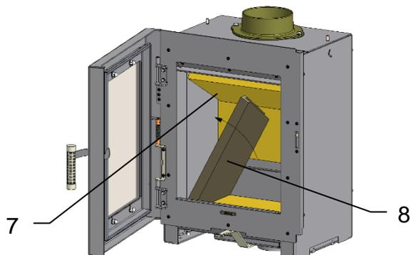
Insérer la pierre latérale gauche (8) avec biais vers la plaque de fond et la pousser vers le côté du foyer ; hausser légèrement la plaque supérieure (7) et la mettre dans la feuillure de la pierre latérale (8).
