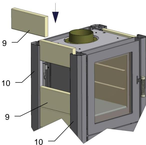
Insérer les pierres latérales (9) avec le bord biseauté vers l'extérieur, d'en haut dans les profils d'angle (10) et les faire glisser vers le bas.
