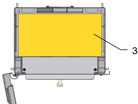
Placer la plaque de sol (3) dans la chambre de combustion face vers le haut, l'ajuster et la pousser vers l'avant.
