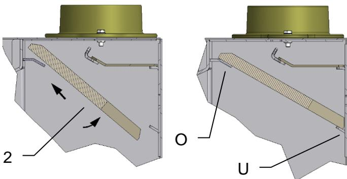
Installer le déflecteur (2) comme illustré dans le foyer en le posant sur le support supérieur (O) et sur celui de l'arrière (U).
