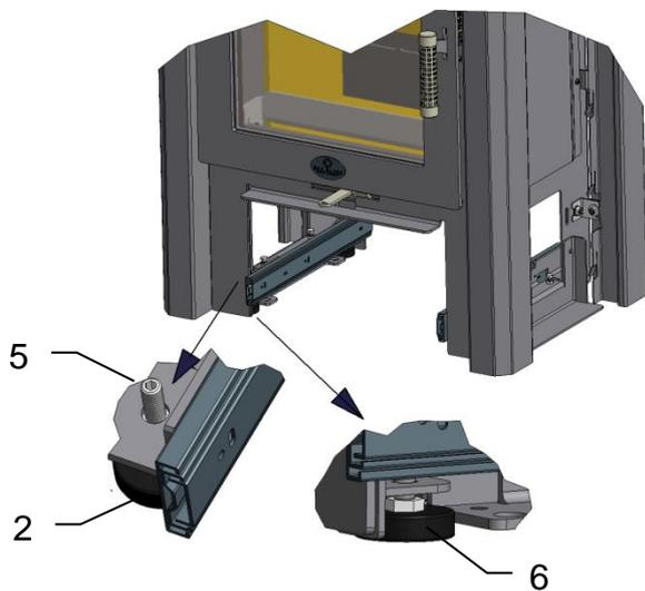
Ensuite régler la position du poêle (1) en tournant les pieds (2) avec une clé à six pans dans la tige (5) ou avec une clé plate sur l'écrou (6).
