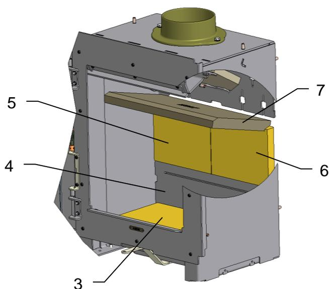
Placer le dégazeificateur (4) derrière la plaque de sol (3) et l'ajuster. Ensuite pousser la plaque de sol (3) vers l'arrière.
