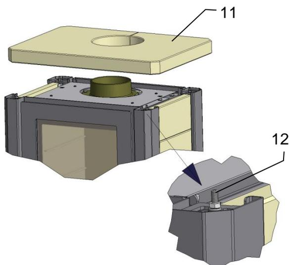
Placer le couvercle pierre (11) sur le poêle de manière à ce que les tiges de fixation (12) s'engagent bien dans les percements sous le couvercle (11).
