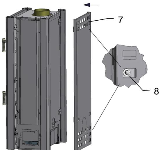
Placer le dossier (7) de l'arrière sur les quatre tiges filetées et le visser avec rondelles et écrous (8).
