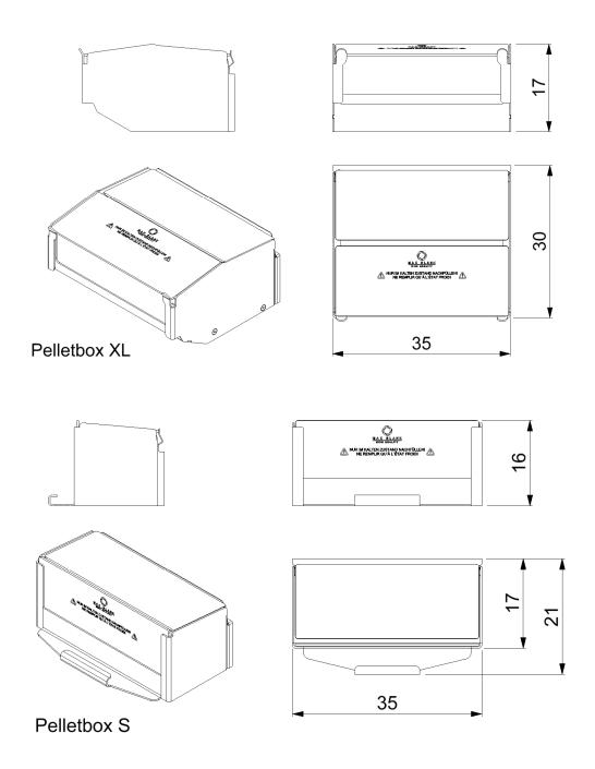
Die Pelletbox XL und S ist in folgenden Modellen mit dem Brennraum KO2-S2 einsetzbar:
