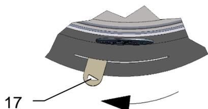
L'air nécessaire à la combustion est réglé par la manette de réglage (17).
