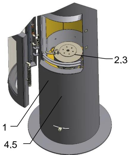
Dès que le cendrier (5), la bague d'adaptation (4), la cassette à pellets (1) ainsi que le couvercle (2) avec le brûleur articulé (3) sont installés, le poêle est prêt pour fonctionner au pellet.
