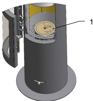
Remplir à ras bord la cassette à pellets KO8 (1) installée dans le foyer avec 2,2 kg de pellets Ø 6 mm.
