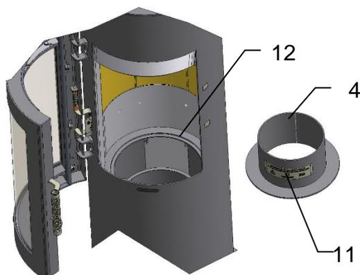
Insérer la bague d'adaptation (4) dans le plancher (12) du foyer en faisant attention que plaquette d'identification (11) se trouve vers l'avant.
