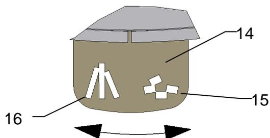
Le symbole (15) montre le fonctionnement au mode pellets. Le symbole (16) montre le fonctionnement au mode bois
