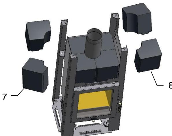
Disposer les pierres comme illustré ci-contre avec la rainure vers le bas : les pierres (7) devant à gauche et derrière à droite, les pierres (8) devant à droite et derrière à gauche.
