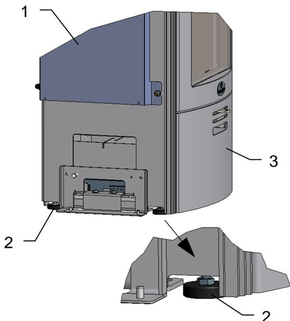
Si nécessaire, régler la position du poêle (1) à l'aide des pieds ajustables (2). Il est possible de les régler de l'extérieur avec une clé plate.
