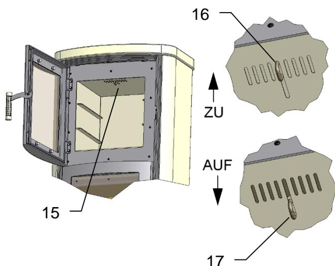
Au plafond à l'intérieur du four se trouve le réglage de l'aspiration (15).
