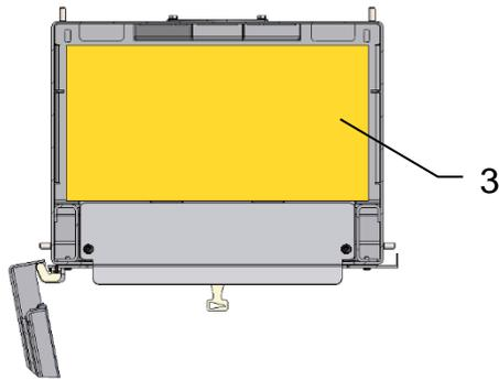
Placer la plaque de sol (3) dans la chambre de combustion face vers le haut, l'ajuster et la pousser vers l'avant.
