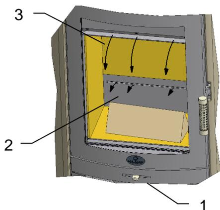
L'air nécessaire pour la combustion sera réglé par la manette de réglage d'air (1). L'air primaire (2) et l'air secondaire (3) sont réglés avec une seule manette (1).
