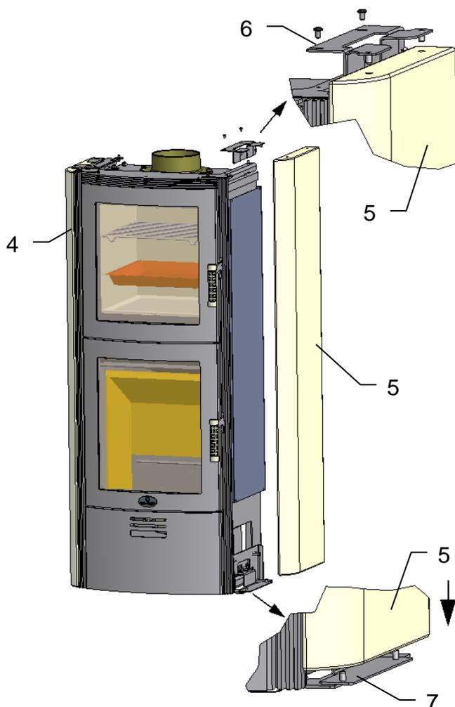
Insérer la pierre latérale droite (5) dans les tiges sur la plaque de fixation (7) en bas.
