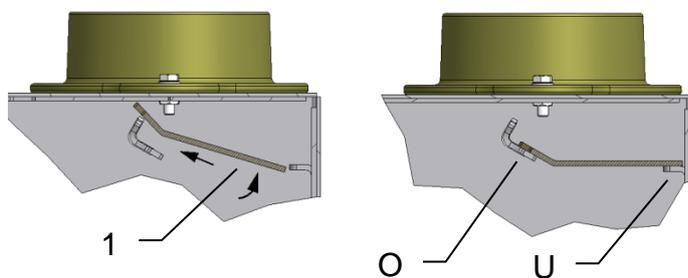
Installer le déflecteur en acier (1) comme illustré dans le foyer en le posant sur le support supérieur (O) et sur celui de l'arrière (U).
