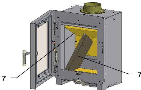
Insérer la pierre latérale gauche (8) avec biais vers la plaque de fond et la pousser vers le côté du foyer ; hausser légèrement la plaque supérieure (7) et la mettre dans la feuillure de la pierre latérale (8).
