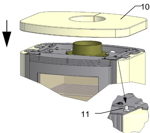
Poser le couvercle en pierre (10) sur le poêle de manière à ce que les tiges de fixation (11) s'engagent bien dans les percements sous le couvercle (10).
