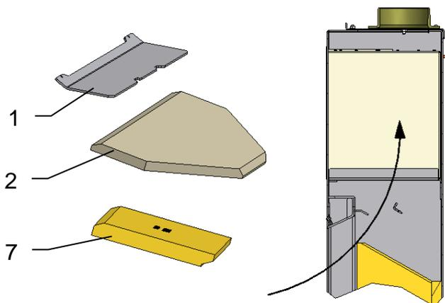
Pour le nettoyage du conduit, démonter les déflecteurs (1) et (2), ainsi que la plaque supérieure (7)
