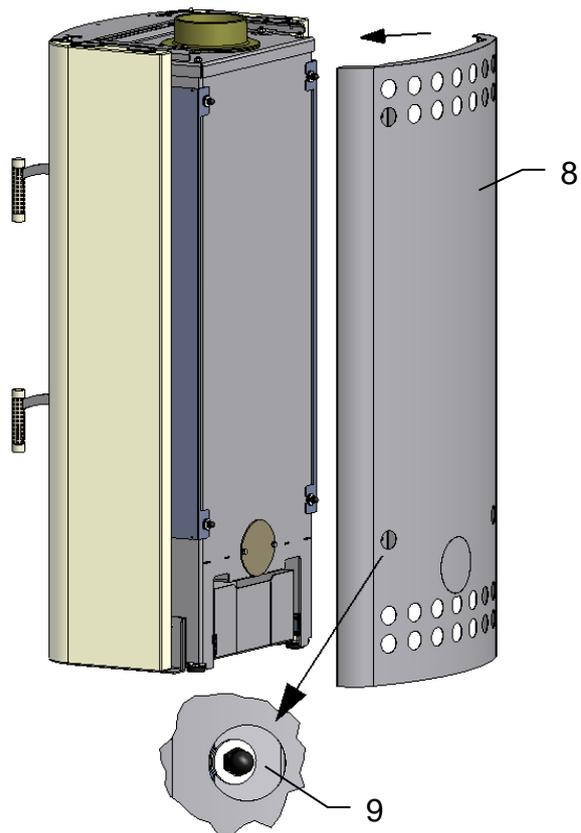
Poser le dosseret (8) de l'arrière sur les 4 tiges filetées et le visser avec écrous (9) et rondelles.
