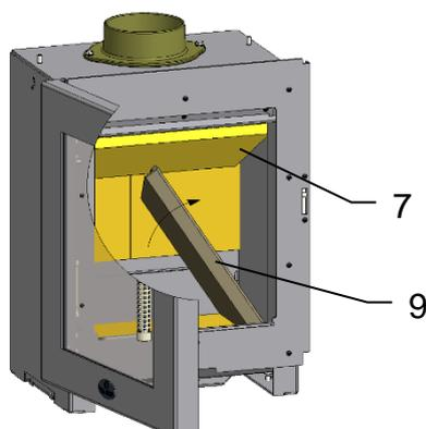
Insérer la pierre latérale droite (9) dans la chambre de combustion et la pousser vers le côté du foyer.
