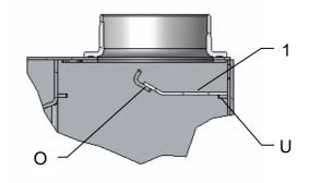
Umlenkplatte (1) wie abgebildet auf obere Auflageplatte (O) und hinteren Auflagewinkel(U) ablegen.
