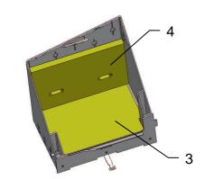
Bodenplatte (3) mit Sichtseite nach oben entsprechend der Ofenkontur einlegen und nach vorne schieben.
