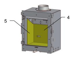
Linken Seitenstein (5) mit Schräge zum Rückwandstein (4) einsetzen und an die Feuerraumseitenwand schieben.
