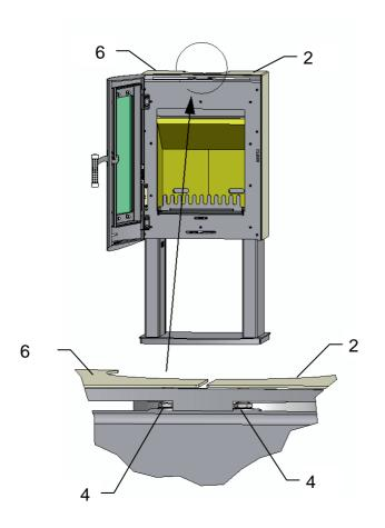
Die beiden Seitenverkleidungen (2) (6) zueinander ausrichten und mit den Muttern (4) fixieren.
