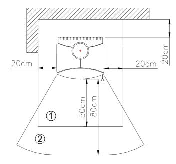
Im **Sichtbereich** des Feuers (Strahlungsbereich) muss ein Abstand von 80 cm zu brennbaren Bauteilen eingehalten werden.
