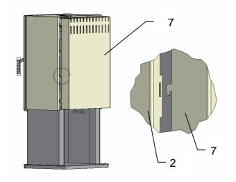
Die Rückwand (7) mit den Haken in die Seitenverkleidungen (2) (6) einhängen und nach unten drücken.
