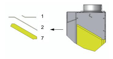
Zum Reinigen der Ofenrohre können die Umlenkplatten (1) und (2), sowie die Deckelplatte (7) entfernt werden.
