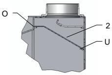
Umlenkplatte (2) wie abgebildet auf oberer Auflageplatte (O) und hinteren Auflagewinkel(U) ablegen.
