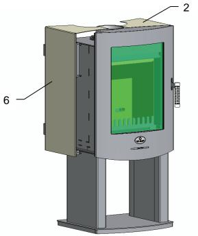
Die Montage der linken Seitenverkleidung (6) erfolgt analog.
