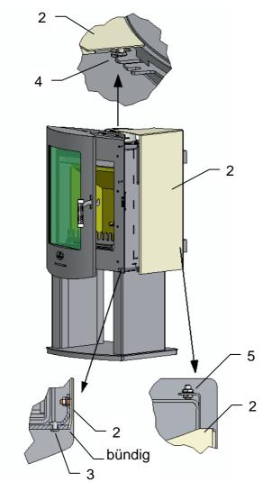
Die rechte Seitenverkleidung (2) in die Lasche (4) und den Gewindebolzen an der Rückwand (5) positionieren.
