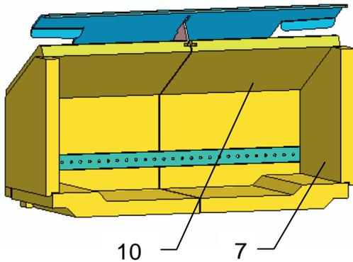
Zum Einbau des Umlenksteines den Seitenstein (7) etwas nach innen kippen und den Umlenkstein (10) auf den Seitenstein (7) auflegen
