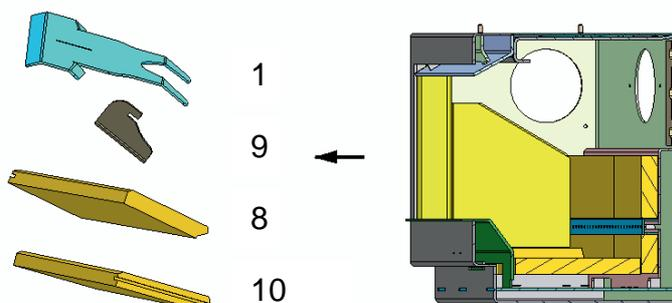
Zum Reinigen der Ofenrohre kann das Umlenblech (1) mit Schamottehalter (9) und die Umlenplatten (8), (10) entfernt werden.
