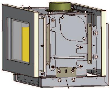
Durch festdrehen der Muttern (9) und Schrauben (8) den Kaminofen mit der Wandkonsole befestigen.
