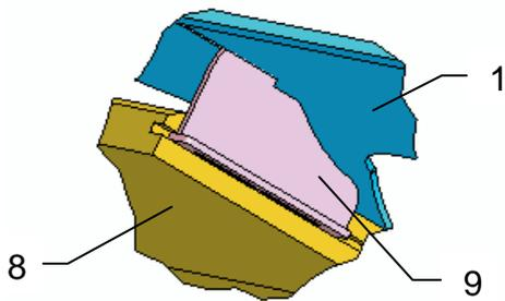
Schamottehalter (9) muss wie abgebildet in Umlenblech (1) und Umlenplatte (8) positioniert sein.
