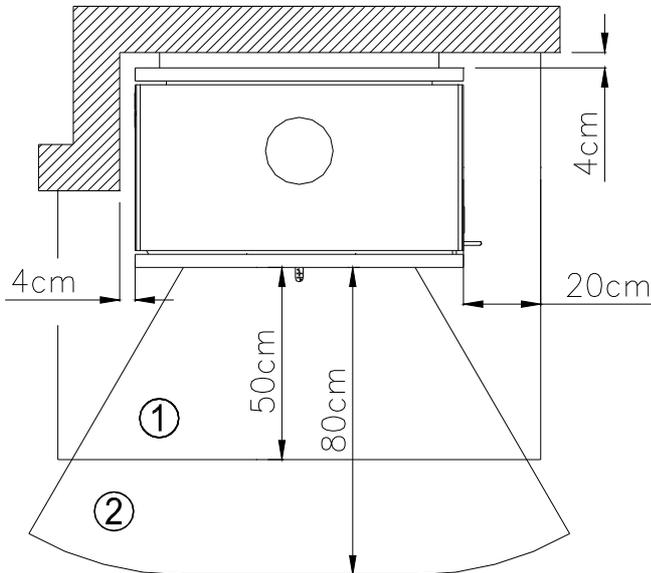
Im **Sichtbereich** des Feuers (Strahlungsbereich) muss ein Abstand von 80 cm zu brennbaren Bauteilen eingehalten werden.
