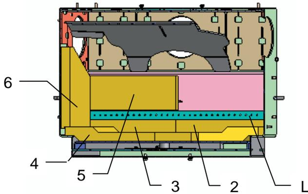
Rückwandstein unten/rechts (2) und Rückwandstein unten/links (3) einsetzen.
