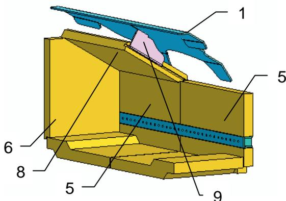
Umlenkstein links (8) mit abgeschrägter Kante auf Rückwandstein (5) und in den Falz von Seitenstein (6) legen.
