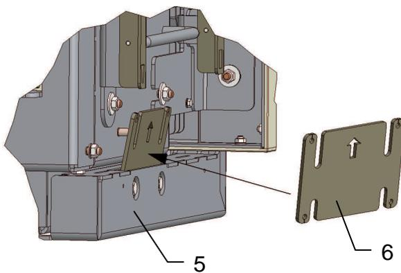
Die Verbindungsplatten (6) in die Aussparung der Wandkonsole (5) einfahren.
