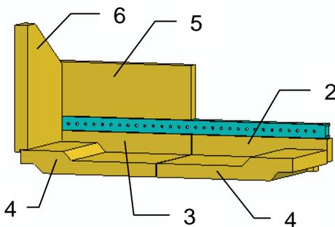
Seitenstein (6) mit Schräge zum Rückwandstein (5) einsetzen.
