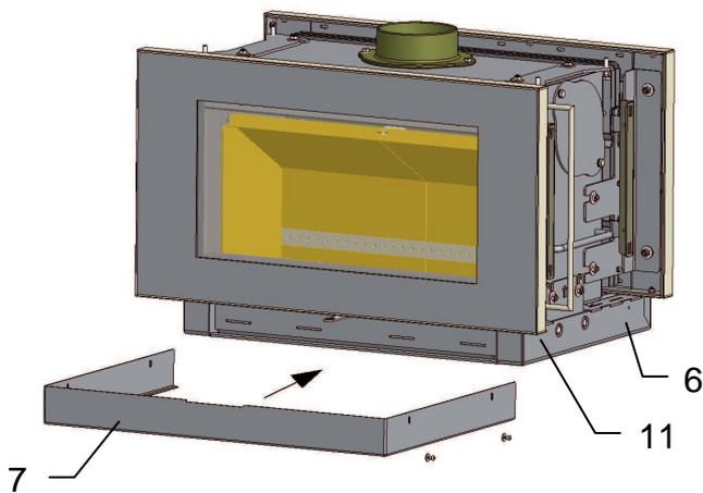
Die Blende (7) von vorne auf die Wandkonsole (6) schieben und mit den Schrauben (11) befestigen.
