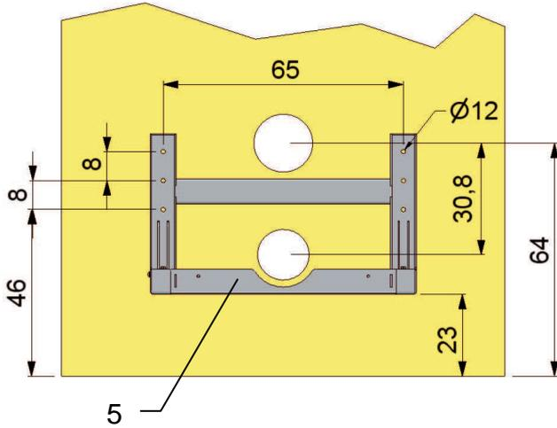
Die Wandkonsole (5) mit 6 Schrauben nach Skizze an die Wand dübeln.
