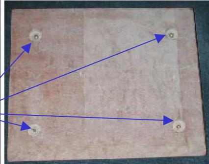
2. Platte umdrehen und an den Aufstellplatz legen, anschließend die Platte mit den Einstellschrauben ausrichten.( Wasserwaage )
