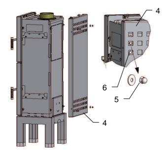
Die Rückwand (4) durch Lösen der Hutmuttern (5) abnehmen. Darauf achten, dass die Anschlagschrauben (6) nicht verdreht werden, diese sind voreingestellt.
