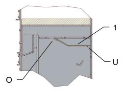
Umlenkplatte (1) wie abgebildet auf obere Auflageplatte (O) und hinteren Auflagewinkel(U) ablegen.
