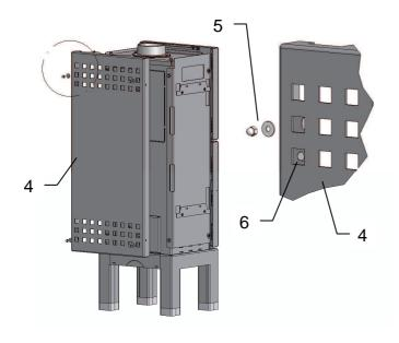
Die Rückwand (4) von hinten auf die vier Gewindebolzen stecken und mit Beilagscheiben und Hutmuttern (5) verschrauben.
