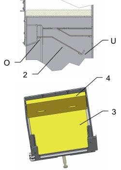
Umlenkplatte (2) wie abgebildet auf oberer Auflageplatte (O) und hinteren Auflagewinkel(U) ablegen.
