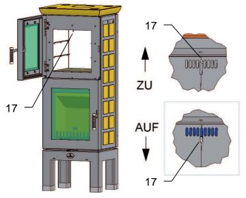
Im Backfach oben befindet sich der Dampfabzugsschieber (17).
