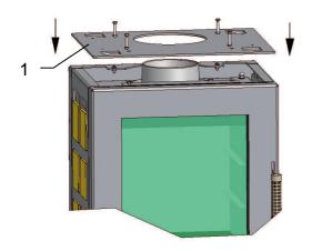
Die Zwischenplatte (1) wieder auf den Kaminofen legen. Diese wird durch 4 Schrauben fixiert.
