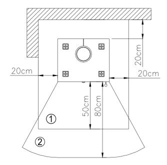
Im **Sichtbereich** des Feuers (Strahlungsbereich) muss ein Abstand von 80 cm zu brennbaren Bauteilen eingehalten werden.
