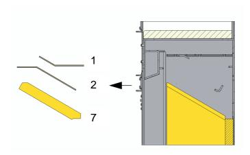
Zum Reinigen können die Umlenkplatten (1) und (2), sowie die Deckelplatte (7) entfernt werden.
