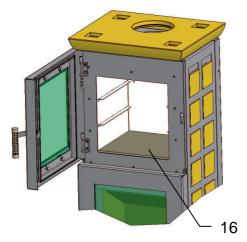
Beim Einlegen des Backfachbodens (16) darauf achten, dass die Flach-Dichtungen (14) nicht verschoben werden.
